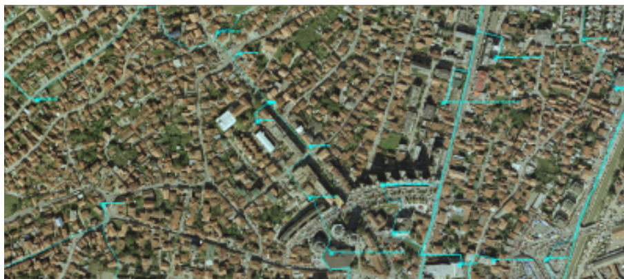
sl. 3: Prikaz vodova i TS X/0.4 kV na na digitalizovanoj georeferenciranoj podlozi
